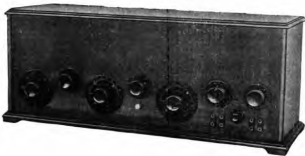
APPARECCHIO tipo R 14 per aereo con due stadi equilibrati di amplificazione in alta frequenza per la ricezione delle radio diffusi Europee da metri 200 a 2000 in altoparlante anche durante il funzionamento di stazioni locali.
