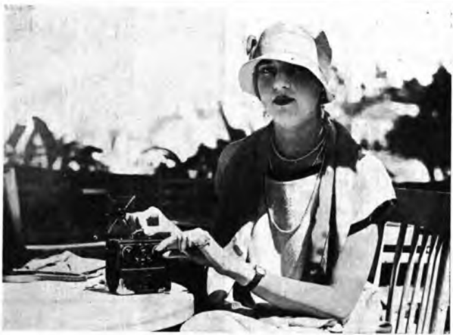
Questo minuscolo radiorecettore portatile consente un'ottima ricezione di stazioni entro un raggio di 100 km. Per l'audizione non occorre altro che la cuffia o l'altoparlante essendo tutti gli altri accessori contenuti nell'apparecchio stesso.
