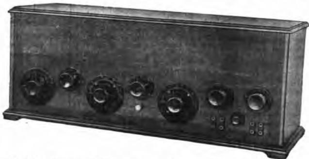
APPARECCHIO tipo R 14 per aereo con due stadi equilibrati di amplificazione in alta frequenza per la ricezione delle radio diffusions europee da metri 200 a 2000 in altoparlante anche durante il funzionamento di stazioni locali,
