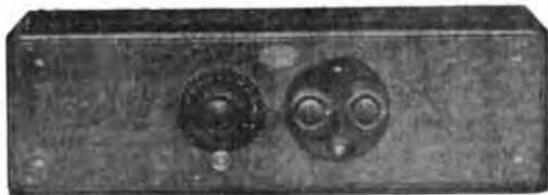
Cassetta in legno oro - Pannello in alluminio - Un solo comando con verniero - Due reostati Peso Kg. 5.100 - Dimensioni cm. 50x15.
