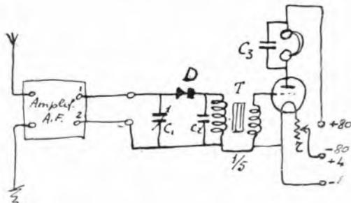
quale D, è il suo detector a galena, C1, è il condensatore variabile da 0,00025, C2 è il condensatore fisso da 0,001 Mfd, C3 il condensatore da 0,002 Mfd, T il trasformatore B. F. ed r il reostato 30 ohm.
