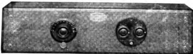
Cassetta in legno oro - Pannello in alluminio - Un solo comando - Due reostati - Peso Kg. 5.350
