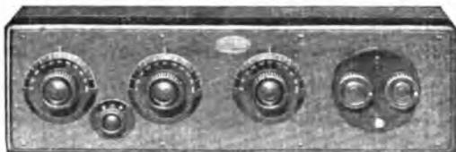
Cassetta in legno oro - Pannello in alluminio - Tre quadranti - Due reostati - Contattore d'antenna
