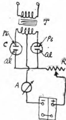
tura di borace ed elettrodi piombo-alluminio superficie un decimetro quadrato). Con questo dispositivo si ottiene il raddrizzamento di entrambi i semiperiodi; sopprimendo una cella e metà del secondario si ottiene il raddrizzamento semplice.
