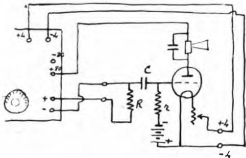
Collegherà le batterie all'apparecchio nel modo normale. Usi una valvola di potenza.
