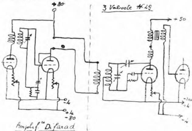
possibilità, potenza e selettività. I collegamenti delle batterie dell'amplificatore andranno spostati nel senso che il -80 anziché essere congiunto al -1 lo sarà al -4.
