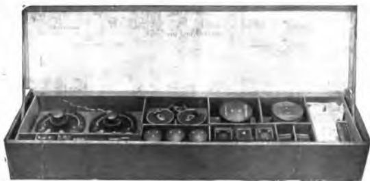
Apparecchio ricevente a otto valvole Supereterodina
