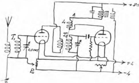
Il trasformatore T1 sarà disposto verticalmente; T2 orizzontalmente e la bobina di reazione L, accoppiabile più o meno strettamente ad una estremità del tubo.
