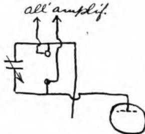
Può migliorarlo facendolo precedere dall'amplificatore ad A. E. illustrato sul N. 50 1926 « Radiorario »; in tal caso disporrà il condensatore d'aereo in parallelo con la bobina (175 spire) come da schizzo qui riprodotto. Collegherà i morsetti 1 e 2 dell'amplificatore al posto della bobina L e scirtatta.
