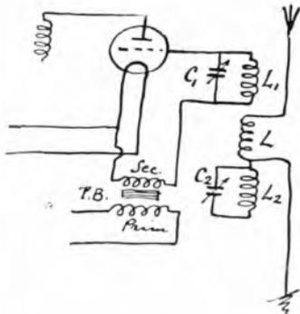
Le bobine L<sub>1</sub> ed L<sub>2</sub> sono a nido d'api ed affacciate ad una distanza di 10 mm. L<sub>1</sub> da L<sub>2</sub> e quasi a contatto L<sub>1</sub> con L<sub>2</sub>.
