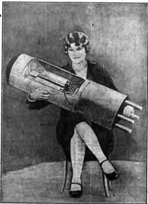
Ecco la più grossa valvola del mondo. Misura 1 metro e 50 cm. di lunghezza e 50 cm. di diametro. E' stata esposta a Boston.
