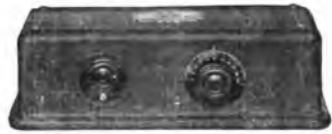
APPARECCHIO modello 35 - Tutto in metallo — Comporta un circuito a 6 valvole delle quali 3 amplificatrici in A.F., accordate-compensate, una detritrice, 2 amplificatrici in B.F. — un solo reostato per l'accensione delle valvole — UN SOLO COMANDO per la ricerca delle stazioni. Dimensioni cm. 41x15x16,50 — Peso Kg. 5,60
