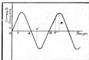
Fig. 21. — Rappresentazione grafica di una corrente alternata.
