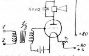
Collegherà i due morsetti 1 e 2 ai morsetti della cuffia sul suo apparecchio; le batterie sono le medesime.
