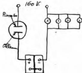
Usi quattro lampadine da 100 candele a filam. metallico monowatt, in parallelo.
