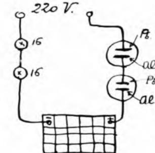
a filamento metallico monofanti da 16 candele 110 volt disposte in serie e due celle elettrolitiche da 1/4 di litro di capacità.
