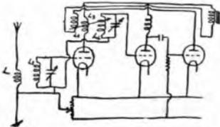
L1-L2 accoppiamento fisso a 10 mm. di distanza; L3-L4-L5 accoppiatore a tre induttanze
