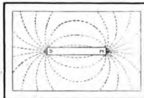
Fig. 23. — Campo magnetico nelle vicinanze di un magnete rettilineo.
