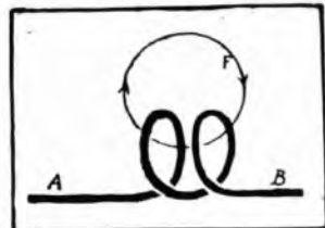
Fig. 28. — Concatenamento di una linea di forza con due spire di un conduttore.
