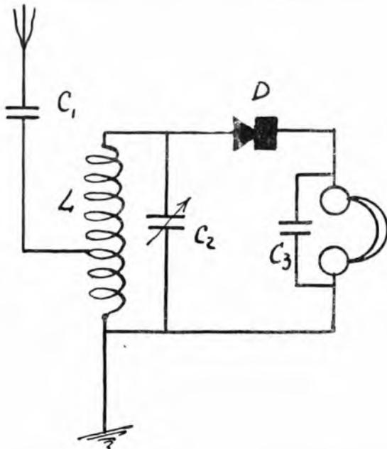
re la ricezione in cuffia della nostra nuova stazione radiofonica di 7 Kw. C è un condensatore fisso da 0,0003 Mfd.
