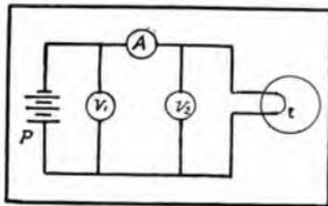
Fig. 29. - Inserzione di un voltmetro ed un amperometro in un circuito elettrico.
