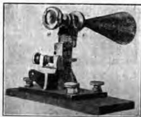
Fig. 3 - Montaggio dello specchio oscillante M al posto trasmettente.
