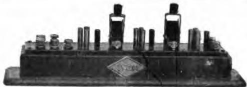
Gli amplificatori UNDA constano di 3 stadi accoppiati a resistenza e capacità e possono essere impiegati in qualsiasi circuito (detrice con o senza reazione, o amplificatore d'alta frequenza con detrice) e sono destinati principalmente ad essere montati negli apparecchi. La specie dell'amplificatore ad alta frequenza è indifferente purché esso funzioni inappuntabilmente (neutrodina, supereterodina ecc.)
