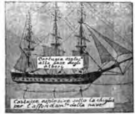
Fig. 5 - Come viene preparata una nave destinata alla distruzione con mezzi telemeccanici.
