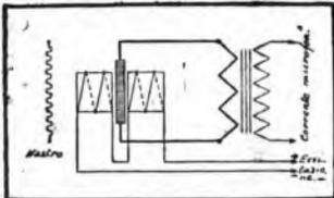
Fig. 72. - Schizzo schematico del microfono a nastro.
