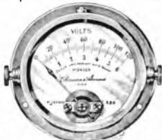
Voltmetro per c. c. Dim. 55 m/m.
