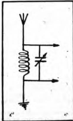
Fig. 74. - Condensatore in parallelo con la bobina d'aereo.
