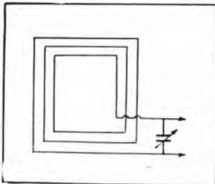
Fig. 81. - Rappresentazione schematica del telaio di ricezione.
