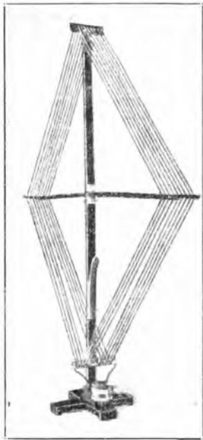
Fig. 83. - Telaio a solenoide.
