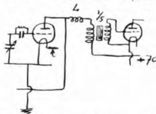
dicato nello schizzo qui riprodotto, una bobina L di 200 spire a nido d'api, disposta ad angolo retto con la bobina a tubo.
