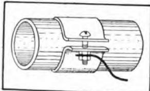
Fig. 80. - Presa di terra alla tubazione d'acqua potabile.
