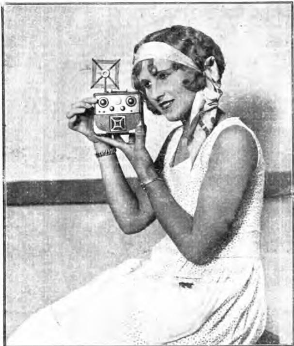
Il più piccolo apparecchio portatile a valvole; col telaio che si vede in netto superiormente esso consente una buona ricezione in piccolo altoparlante (la cui bocca è costituita dall'apertura quadra inferiore della stessa rete locale
