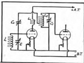
Fig. 110. - Dispositivo neutrodina Hazeltine modificato.
