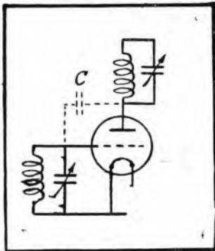
Fig. 106. - Effetto della capacità interna della valvola.
