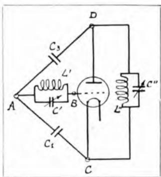
Fig. 113. - Circuito a ponte effettivo nel sistema Difarad.
