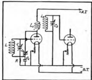
Fig. 111. - Dispositivo neutrodina Difaraf.
