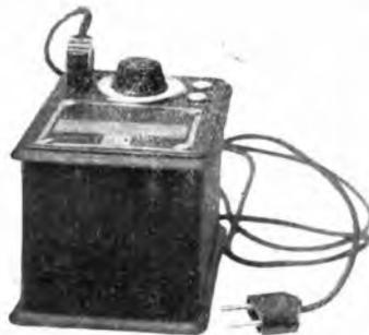
appropriato reostato inserito sul circuito primario del trasformatore permette di regolare l'erogazione del secondario. Il circuito secondario può erogare senza inconvenienti una corrente massima di 12 Amp.
