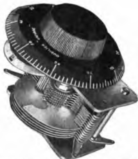
Fig. 152. Tipo speciale di condensatore variabile ad inserimento successiva delle lamine dell'armatura mobile.
