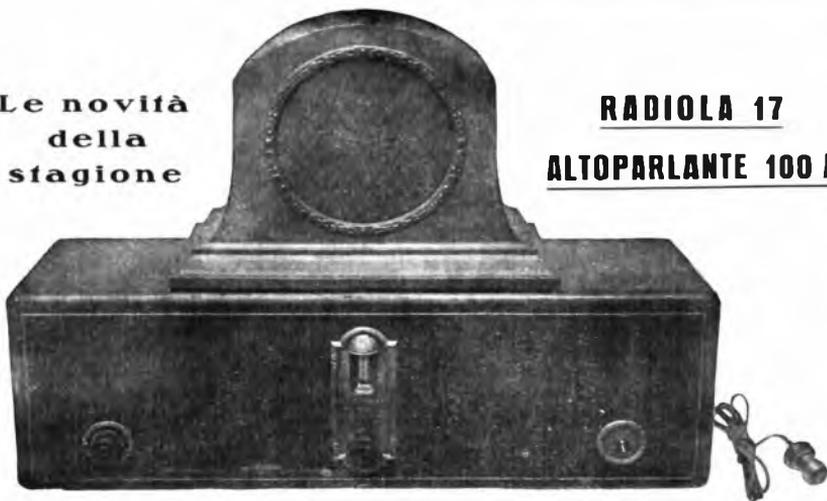
Apparecchio ricevente a 6 Radiorions a comando unico alimentate direttamente dalla corrente alternata. Non occorrono più né accumulatore né batterie anodiche. — Tre stadi di alta frequenza, una detettrice, e due stadi di bassa frequenza.
