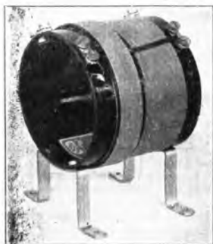
Fig. 163. Trasformatore ad A. F. a bobine cilindriche con primario sovrapposto al secondario
