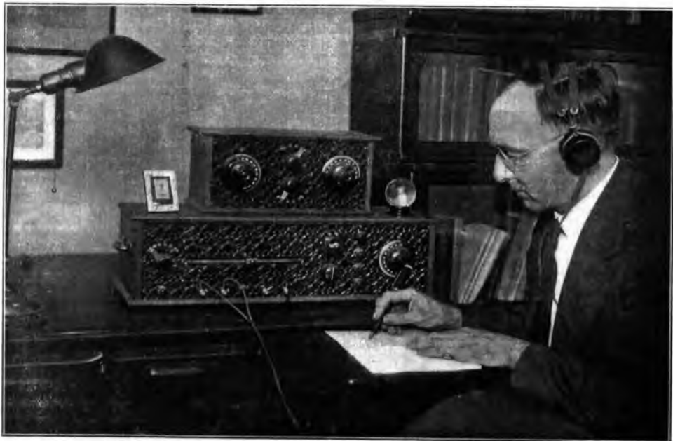
Il Sig. A. Leighton dimorante a Collage City nel Maryland (U. S. A.) riceve regolarmente circa 80 stazioni (parecchie di queste, distanti più di 2000 Km) facendo uso esclusivo di due apparecchi a cristallo, che si scorgono nella nostra fotografia. Queste ricezioni straordinarie sono dovute principalmente alla località favorevolissima.
