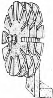
Fig. 171. - Accoppiamento di parecchie bobine a fondo di paniero per ottenere alti valori d'induttanza
