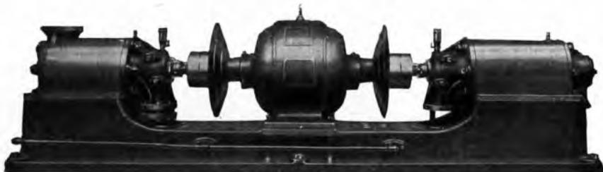
Elettropompa modello Notaresco - Cotonificio Bustese, doppiamente multipla, con 6 + 5 = 11 giranti e Motori da HP. 30. Riceve sotto carico 12 mc/ora di acqua caldissima a 13 atmosfere, e la spinge in caldaia contro 30 atmosfere - Con speciale circolazione di acqua fredda ai cuscinetti della Pompa e sotto il Motore Elettrico per impedirne l'eccessivo riscaldamento in seguito all'acqua bollente
