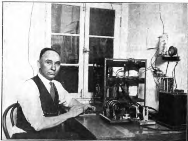
Una delle innumerevoli stazioni ad onda corta di piccola potenza che il governo americano ha disseminato sui suoi territori per dirigere la rotta degli aeroplani adibiti al servizio commerciale
