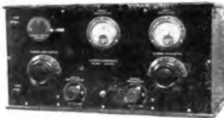
Trasmettitore a cristallo piezo-elettrico a due valvole
