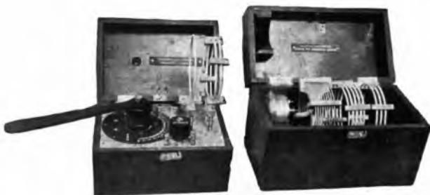
Ondametro onde corte con isolamento in quarzo
