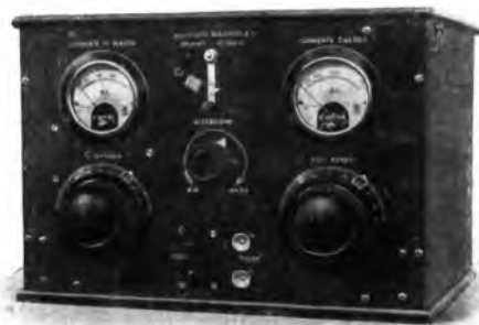
Trasmettitore radiotelegrafico: 30-100 metri
