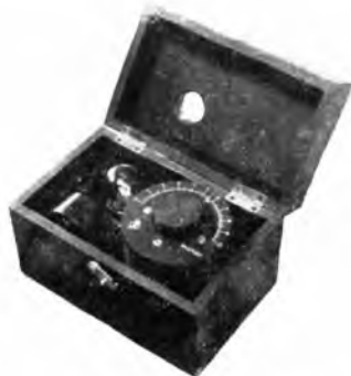
Risonatore a cristallo piezo-elettrico luminescente: 25-1000 metri
