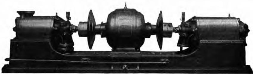
Elettropompa modello Notaresco - Cotonificio Bustese, doppiamente multipla, con 6 l. 5 = 11 giranti e Motori da HP. 30. Riceve sotto carico 12 mcora di acqua caldissima a 13 atmosfere, e la spinge in caldaia contro 39 atmosfere - Con speciale circolazione di acqua fredda ai cuscinetti della Pompa e sotto il Motore Elettrico per impedire l'eccessivo riscaldamento in seguito all'acqua bollente
