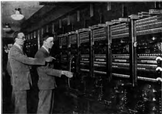
Le numerose stazioni radiodiffonditrici della National Broadcasting Company di New-York sono intercollegate mediante una rete telefonica che fa capo ad una centrale di commutazione della quale è possibile eseguire qualsiasi combinazione di trasmissione dei vari programmi
