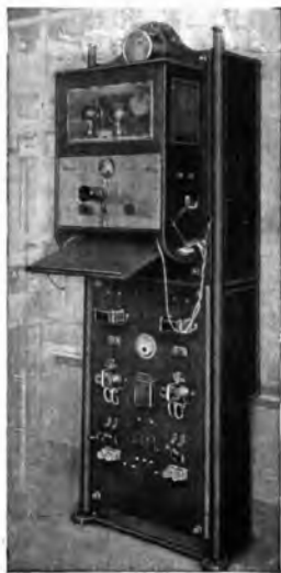
Stazione Radiotelefonica ad onde guidate su linee alta tensione
