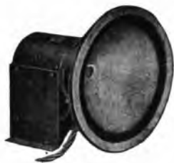
L'Apparecchio "V-8" contiene un diffusore eletto-dinamico B-T, MAGNAVOX, Mod. 1929.
