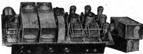
CHASSIS IN ALLUMINIO DEL POTENTE "8"
