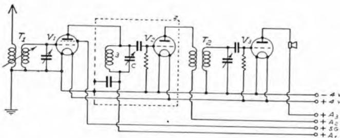
Fig. 1. — Circuito con due stadi ad A.P. di cui uno con valvola schermata. T e  $T_1$  = trasformatori ad A.P.; 3 = bobina a nido d'api;  $V_1$  = valvole schermate;  $V_2$  e  $V_3$  = triodi normali.
