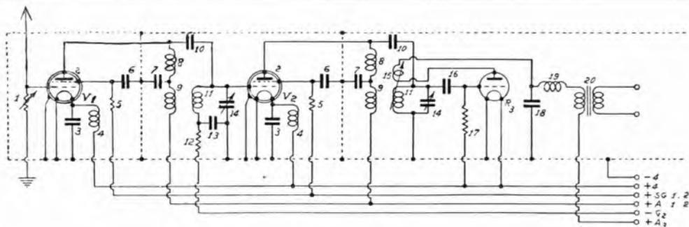
Fig. 4. — Circuito con due stadi ad A.F. a valvole a placca schermata. 1 = resistenza variabile da 50.000 ohm; 4 = «choke» di filamento (60 spire filo 0,4 mm. diam. su manfrino 10 mm. diam. e 20 mm. lunghezza); 5 = resistenza 50.000 ohm; 8-9 = bobine di «choke»; 11 = bobine a nido d'api; 12 = resistenza 10.000 ohm; 15 = bobina di reazione; 19 = bobina di «choke».
