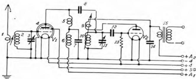
Fig. 2. — Circuito con uno stadio aB.F.P.;  $V_1$  = valvola a placca schermata; 1-2 = variometro d'aereo; 5-6 = bobine di «choke»; 9 = bobina di reazione; 10 = bobina a nido d'api; 15 = trasformatore a B.F.;  $V_2$  = triodo normale.
