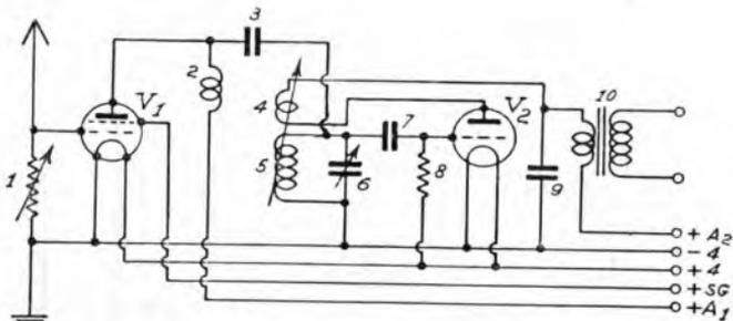
Fig. 3. — Circuito analogo al precedente ma semplificato. 1 = resistenza variabile da 50.000 ohm; 2 = bobina di «choke»; 5 = bobina di reazione; 7 = bobina a nido d'api;  $V_1$  = valvola a placca schermata;  $V_2$  = triodo normale.
