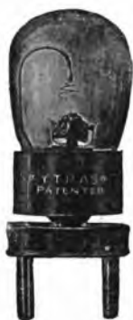
Apparecchio Tipo K con un solo Detector - Induttanza variabile - Forte ricezione in cuffia - Intieramente in metallo
