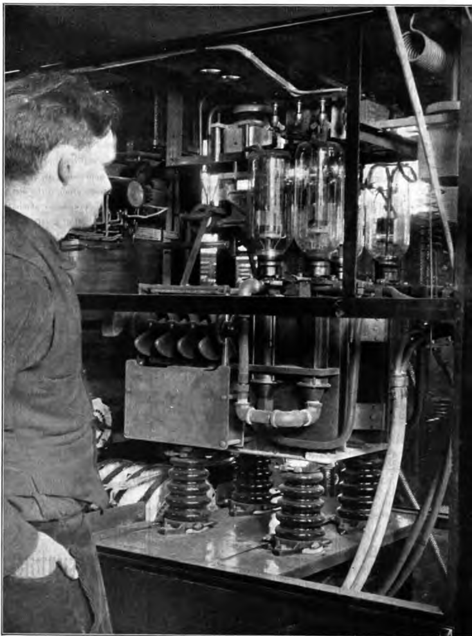
Uno dei più recenti trasmettitori ad onda corta, costruiti dalla Radio Corporation of America per le radio comunicazioni celerissime col sistema a fascio fra l'America e l'Europa
