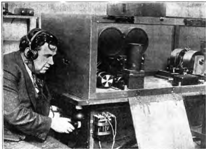
Il Sig. Edoardo Enrico Hansen di fronte all'oscillografoscopia, apparecchio di sua costruzione il quale serve per registrare e fotografare le più deboli pulsazioni del cuore.
