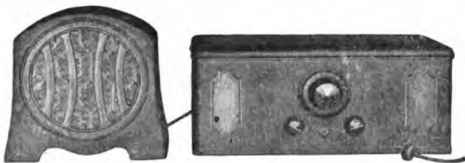
Mod. 3 Q 15 - a 5 valvole di cui una schermata
