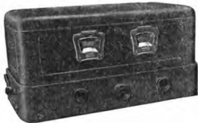
L'R D 30, radiorecettore a 3 valvole elettrico RAM per tutte le lunghezze d'onda
