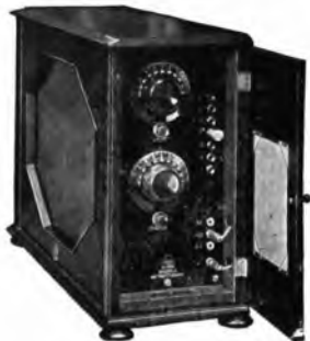
Apparecchio ricevente con diffusore completamente alimentato dalla corrente di illuminazione
