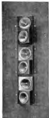
Complesso d'altoparlante usato in grandi installazioni per la proiezione di films sonori.
