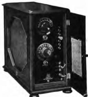
Apparecchio ricevente con diffusore completamente alimentato
