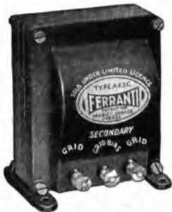
Tipo AF5 - rapp. 1:3% - peso Kg. 1.180 - Dimensioni millimetri 66x76x95 - Impedenza: 580.000 ohms a 500 periodi - 90% d'amplificazione a 50 periodi.
