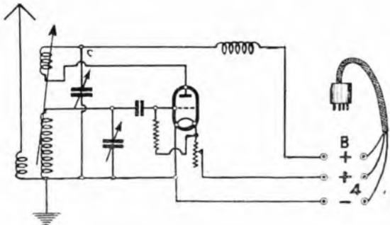
mativamente dallo schema costruttivo. Il collegamento dell'apparecchio ad onda corta con quello normale va effettuato, come più volte ripetuto, mediante un cordone a tre conduttori.
