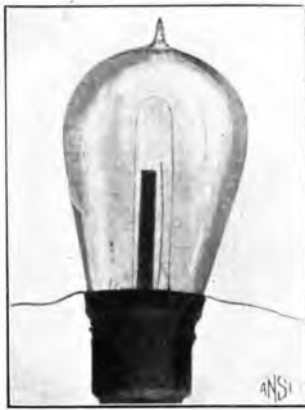
Fig. 6. — Una delle lampadine usate da Edison per lo studio dell'effetto Edison
