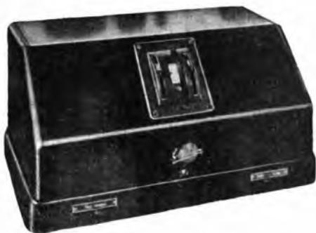
Ricevitore a 4 Valvole fra le quali il nuovo tetrodo schermato MARCONI, ultimo perfezionamento in materia di valvole termioniche.
