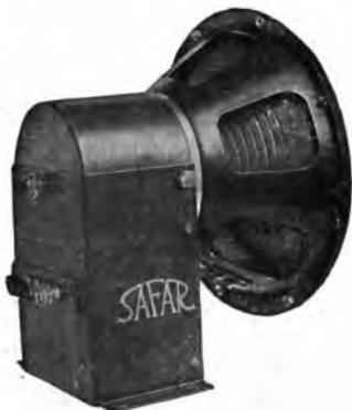
I **DIFFUSORI ELETTRODINAMICI** brevettati SAFAR sono superiori ai soliti tipi per l'originale sospensione elastica che senza frenare gli spostamenti assiali della bobina mobile ne impedisce qualsiasi spostamento laterale mantenendola sempre centrata nell'entraferro pur con il più continuato funzionamento.
