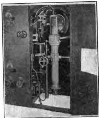
*Amplificatore da 50 Kw-antenna aperto; si notino le dimensioni di una delle valvole da 100 Kw.*
