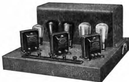
Gli Amplificatori « Brunet », costruiti dagli Etablissements Brunet, di Parigi, sono studiati per funzionare direttamente dalla rete luce a 110 Volta, 42-50 periodi; e servono tanto come amplificatori grammofonici, in unione ad un Pick-Up, quanto come amplificatori radiofonici. Nella loro costruzione sono usati i famosi Trasformatori « Orthoformer ».
