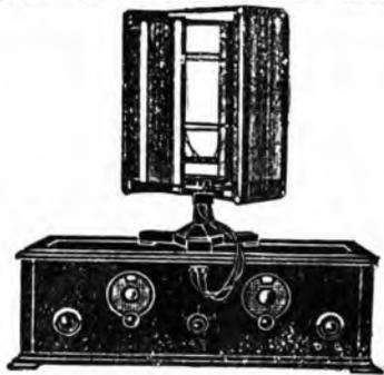
Un apparecchio moderno deve ricevere anche le onde cortissime e le lunghe. Il 6 VALVOLE a RADIONE è l'unico apparato che riceve mediante piccolo telaio in forte allargante le stazioni di onde MEDIE, CORTISIME o LUNGHE, da 12 a 3500 metri. Circuito di Supereterodina, schermato con tre valvole schermate. Perfetta selettività di 7 kilocicli, eliminazione della stazione locale su 2 gradi di manopola. Ottimo riproduttore grammofonico.
