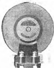
Trasformatore toroidale impiegato nel Toreador SG IV
