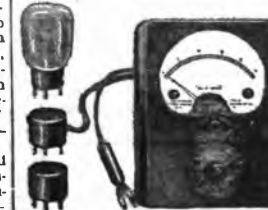
Strumento universale per il controllo diretto del funzionamento di una valvola
