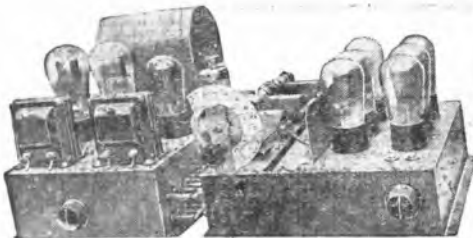
Un amplificatore-alimentatore Tensione di placca, griglia a filamento per valvole in alternata
