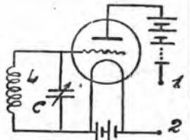
Lo schema di uno stadio di amplificazione in A. F. è dato dalla fig. 1, in cui abbiamo il solito circuito oscillante secondario (quello che riceve le cariche oscillanti indotte da quello primario, collegato al collettore d'onde e che nella figura è omesso). Questo secondario è collegato, da una parte, ad un polo della batteria di accensione del filamento e dall'altra alla griglia della valvola amplificatrice.
