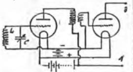
collegato, da una parte, con il filamento della seconda valvola e da un'altra con la griglia di questa stessa valvola. In questo caso lo schema viene modificato secondo la fig. 2 suddetta, che non ha bisogno di maggior chiarimento. In essa vediamo che ai punti 3 e 4 si possono raccogliere le cariche oscillanti, sempre in A. F., captate dal collettore d'onde. In generale tra o quattro stadi in A. F. sono più che sufficienti e non è bene eccedere nel numero di questi.
