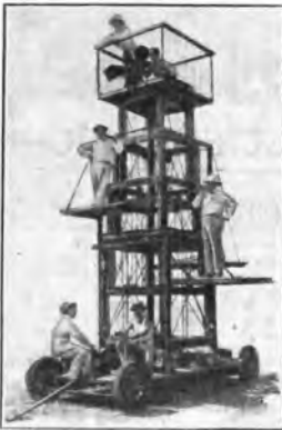
La torretta-automobile che trasporta la macchina cinematografica ed il microfono da un punto all'altro e può essere regolata a diverse altezze.
