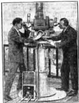
Il cine-todolite, lo strumento col quale si può accertare l'altezza e registrare il movimento di un aeroplano in volo.
