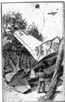
Il segnale di « S. O. S. » di un aereo in pericolo, consistente in un palloncino frenato.
