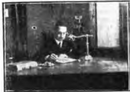
L'arditissimo reggimicrofono che consente di poter telefonare tenendo con le mani libere per pigliare appunti con comodità.
