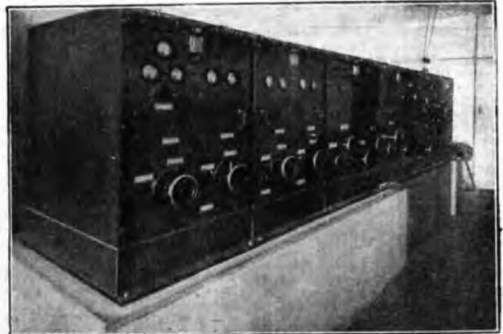
Trasmettitore a onde corte (20 kw.).
