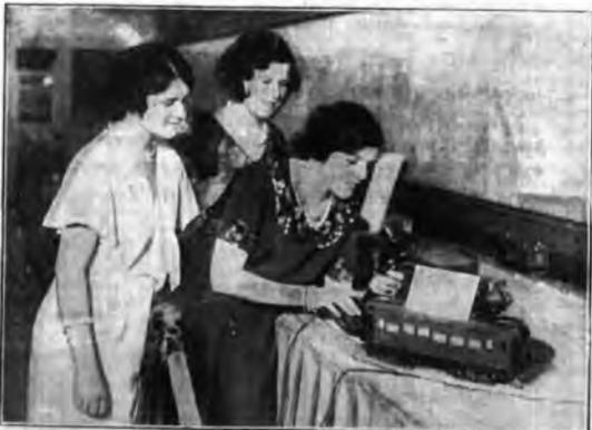
Questo piccolo treno elettrico esegue fedelmente le manovre che gli vengono comandate. Gli ordini sono trasmessi telefonicamente e il movimento del treno dipende dall'intensità del tono di voce.
